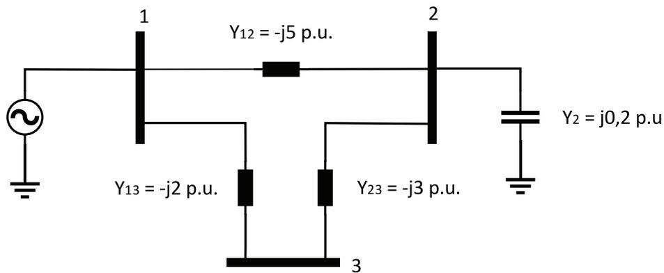
**09.** Se a barra 1 possuir tensão igual a  $0,95\angle 30^\circ \text{ p.u.}$  e a barra 3 possuir  $1\angle 0^\circ \text{ p.u.}$ , determine a potência  $P_{31}$  transmitida da barra 3 para a barra 1.
